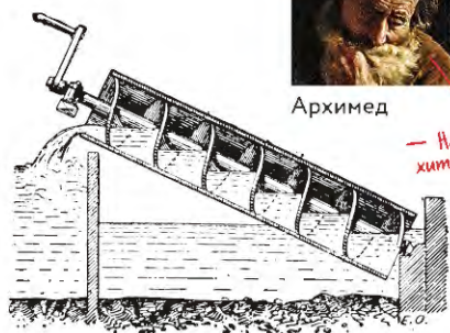
Архимедов винт ручного вращения. Схема в разрезе.
